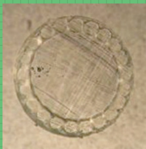
モノ(モノマルチ)の断面図。太い芯糸の周りに細い側糸が巻き付く
